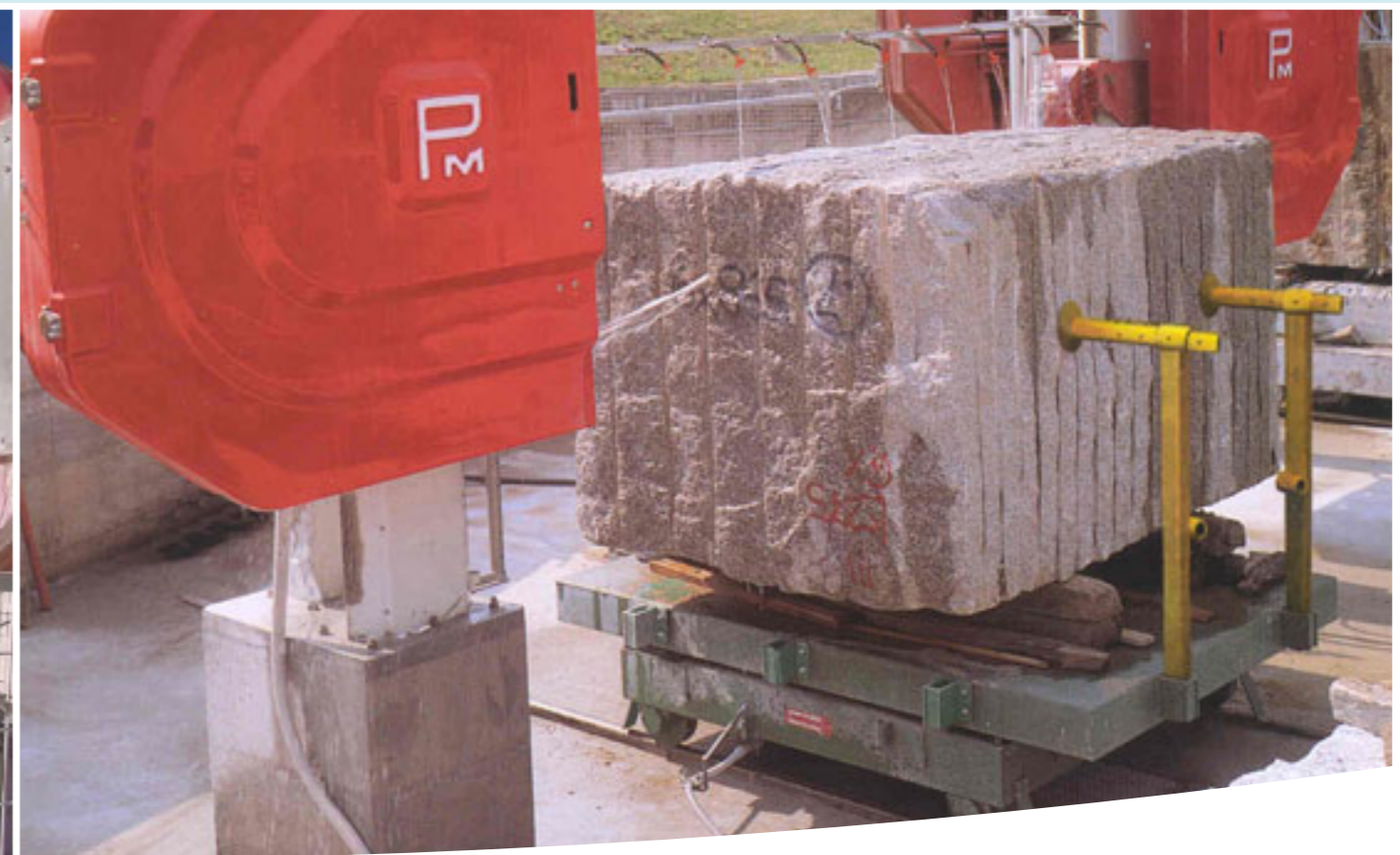
КАНАТНАЯ АЛМАЗНАЯ ПИЛА И 3D ПИЛА (PELEGRINI MECANICA SPA) ИСПОЛЬЗУЕТСЯ ГЛАВНЫМ ОБРАЗОМ ДЛЯ ПЕРЕВЯЗОЧНЫХ И КВАДРАТНЫХ БЛОКОВ И ДЛЯ РЕЗКИ ПЛИТ ЛЮБОЙ ТОЛЩИНЫ. СИСТЕМЫ ДЛЯ РЕЗКИ ДВУХ И ТРЕХМЕРНЫХ ПРОФИЛЕЙ С ИСПОЛЬЗОВАНИЕМ АЛМАЗНОЙ ПРОВОЛОКИ, ПОЛНОСТЬЮ С ЧПУ, УПРАВЛЯЕМЫЕ ПО ОСЯМ 2, 4 ИЛИ 6 DIAMOND ROPE SAW AND 3D SAW (PELEGRINI MECANICA SPA). USED MAINLY FOR DRESSING AND SQUARING BLOCKS AND FOR CUTTING SLABS OF ANY THICKNESS. SYSTEMS FOR CUTTING TWO AND THREE DIMENSIONAL PROFILES USING DIAMOND WIRE, ENTIRELY CNC CONTROLLED ON 2, 4 OR 6 AXES
