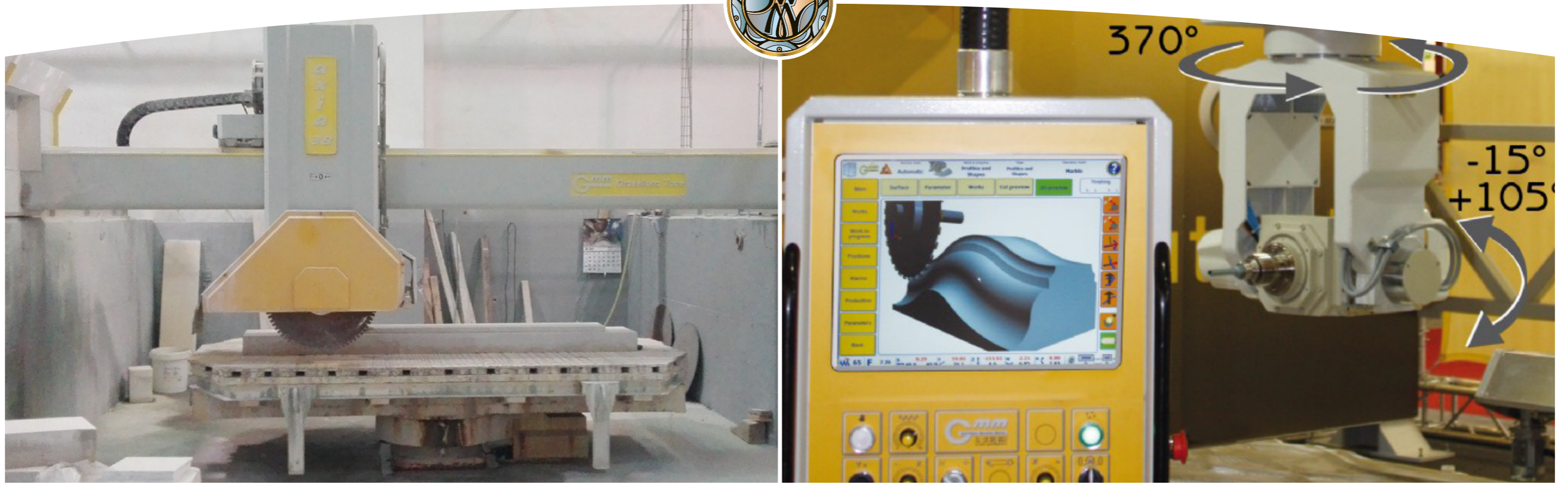
РАСПИЛОВОЧНЫЕ СТАНКИ CNC ZEDA И ТЕСНА ( GMM) - СТАНКИ ДЛЯ ВЫПОЛНЕНИЯ СЛОЖНЫХ РЕЗОВ, ТАКИХ КАК КОНТУРНАЯ И ФАСОННАЯ ОБРАБОТКИ, ВЫПОЛНЕНИЕ БОРДЮРОВ, ОТВЕРСТИЙ, БАРЕЛЬФОВ, НАДПИСЕЙ, ВИНТОВЫХ ИЗДЕЛИЙ CNC SAWING MACHINES ZEDA AND TECNA (GMM) - MACHINES FOR PERFORMING COMPLEX CUTS, SUCH AS CONTOUR AND SHAPED MACHINING, CURBS, HOLES, BAS-RELIEFS, INSCRIPTIONS, SCREW PRODUCTS
