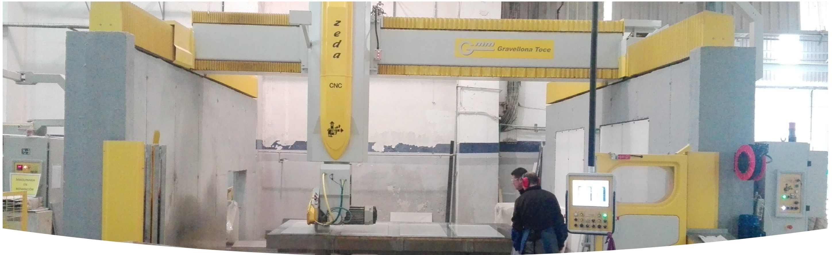
РАСПИЛОВОЧНЫЕ СТАНКИ CNC ZEDA И ТЕСНА ( GMM) - СТАНКИ ДЛЯ ВЫПОЛНЕНИЯ СЛОЖНЫХ РЕЗОВ, ТАКИХ КАК КОНТУРНАЯ И ФАСОННАЯ ОБРАБОТКИ, ВЫПОЛНЕНИЕ БОРДЮРОВ, ОТВЕРСТИЙ, БАРЕЛЬФОВ, НАДПИСЕЙ, ВИНТОВЫХ ИЗДЕЛИЙ CNC SAWING MACHINES ZEDA AND TECNA (GMM) - MACHINES FOR PERFORMING COMPLEX CUTS, SUCH AS CONTOUR AND SHAPED MACHINING, CURBS, HOLES, BAS-RELIEFS, INSCRIPTIONS, SCREW PRODUCTS
