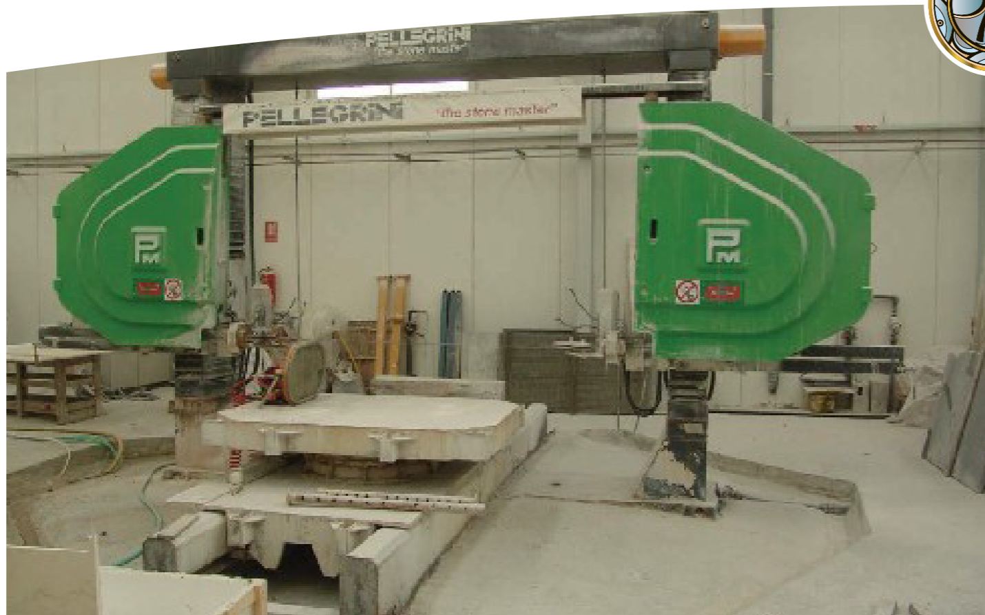
КАНАТНАЯ АЛМАЗНАЯ ПИЛА И 3D ПИЛА (PELEGRINI MECANICA SPA) ИСПОЛЬЗУЕТСЯ ГЛАВНЫМ ОБРАЗОМ ДЛЯ ПЕРЕВЯЗОЧНЫХ И КВАДРАТНЫХ БЛОКОВ И ДЛЯ РЕЗКИ ПЛИТ ЛЮБОЙ ТОЛЩИНЫ. СИСТЕМЫ ДЛЯ РЕЗКИ ДВУХ И ТРЕХМЕРНЫХ ПРОФИЛЕЙ С ИСПОЛЬЗОВАНИЕМ АЛМАЗНОЙ ПРОВОЛОКИ, ПОЛНОСТЬЮ С ЧПУ, УПРАВЛЯЕМЫЕ ПО ОСЯМ 2, 4 ИЛИ 6 DIAMOND ROPE SAW AND 3D SAW (PELEGRINI MECANICA SPA). USED MAINLY FOR DRESSING AND SQUARING BLOCKS AND FOR CUTTING SLABS OF ANY THICKNESS. SYSTEMS FOR CUTTING TWO AND THREE DIMENSIONAL PROFILES USING DIAMOND WIRE, ENTIRELY CNC CONTROLLED ON 2, 4 OR 6 AXES
