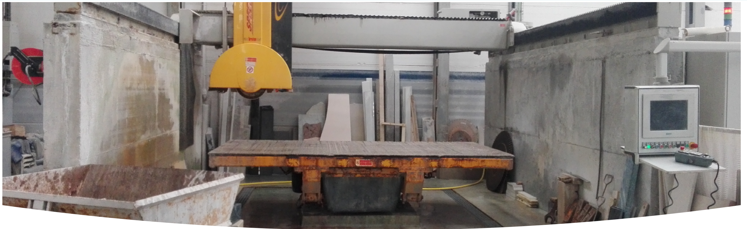
РАСПИЛОВОЧНЫЕ СТАНКИ COUNTOUR, FUEGO4, SMARTCUT 800 (BRETON) АВТОМАТИЧЕСКИЕ РАБОЧИЕ ЦЕНТРЫ С ПРОГРАММНЫМ ОБЕСПЕЧЕНИЕМ, ДЛЯ ПРОФИЛИРОВАНИЯ, ОБРАМЛЕНИЯ, ФРЕЗЕРОВАНИЯ, СГЛАЖИВАНИЯ И СВЕРЛЕНИЯ ИЗДЕЛИЙ ИЗ МРАМОРА, ГРАНИТА, ИЗГОТОВЛЕНИЯ СКУЛЬПТУР И РЕЛЬЕФОВ SAWING MACHINERY COUNTOUR, FUEGO 4, SMARTCUT 800 (BRETON) AUTOMATIC WORKING CENTERS WITH SOFTWARE FOR PROFILING, FRAMING, MILLING, SMOOTHING AND DRILLING PRODUCTS FROM MARBLE, GRANITE, MAKING SCULPTURES AND RELIEFS
