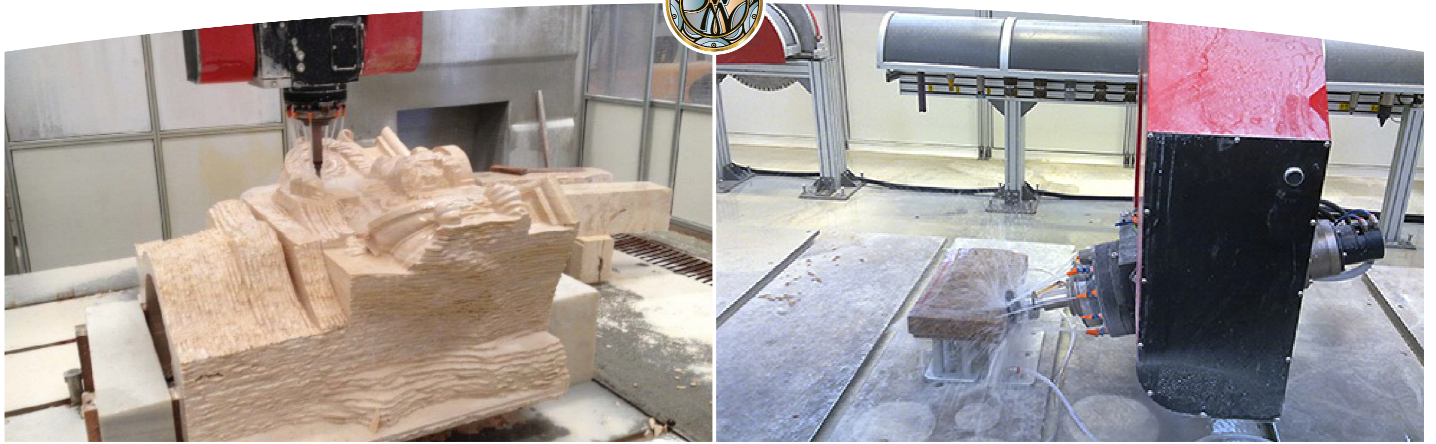
РАСПИЛОВОЧНЫЕ СТАНКИ COUNTOUR, FUEGO4, SMARTCUT 800 (BRETON) АВТОМАТИЧЕСКИЕ РАБОЧИЕ ЦЕНТРЫ С ПРОГРАММНЫМ ОБЕСПЕЧЕНИЕМ, ДЛЯ ПРОФИЛИРОВАНИЯ, ОБРАМЛЕНИЯ, ФРЕЗЕРОВАНИЯ, СГЛАЖИВАНИЯ И СВЕРЛЕНИЯ ИЗДЕЛИЙ ИЗ МРАМОРА, ГРАНИТА, ИЗГОТОВЛЕНИЯ СКУЛЬПТУР И РЕЛЬЕФОВ SAWING MACHINERY COUNTOUR, FUEGO 4, SMARTCUT 800 (BRETON) AUTOMATIC WORKING CENTERS WITH SOFTWARE FOR PROFILING, FRAMING, MILLING, SMOOTHING AND DRILLING PRODUCTS FROM MARBLE, GRANITE, MAKING SCULPTURES AND RELIEFS
