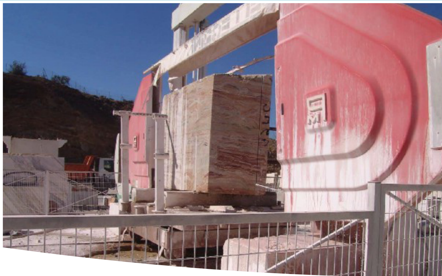
КАНАТНАЯ АЛМАЗНАЯ ПИЛА И 3D ПИЛА (PELEGRINI MECANICA SPA) ИСПОЛЬЗУЕТСЯ ГЛАВНЫМ ОБРАЗОМ ДЛЯ ПЕРЕВЯЗОЧНЫХ И КВАДРАТНЫХ БЛОКОВ И ДЛЯ РЕЗКИ ПЛИТ ЛЮБОЙ ТОЛЩИНЫ. СИСТЕМЫ ДЛЯ РЕЗКИ ДВУХ И ТРЕХМЕРНЫХ ПРОФИЛЕЙ С ИСПОЛЬЗОВАНИЕМ АЛМАЗНОЙ ПРОВОЛОКИ, ПОЛНОСТЬЮ С ЧПУ, УПРАВЛЯЕМЫЕ ПО ОСЯМ 2, 4 ИЛИ 6 DIAMOND ROPE SAW AND 3D SAW (PELEGRINI MECANICA SPA). USED MAINLY FOR DRESSING AND SQUARING BLOCKS AND FOR CUTTING SLABS OF ANY THICKNESS. SYSTEMS FOR CUTTING TWO AND THREE DIMENSIONAL PROFILES USING DIAMOND WIRE, ENTIRELY CNC CONTROLLED ON 2, 4 OR 6 AXES
