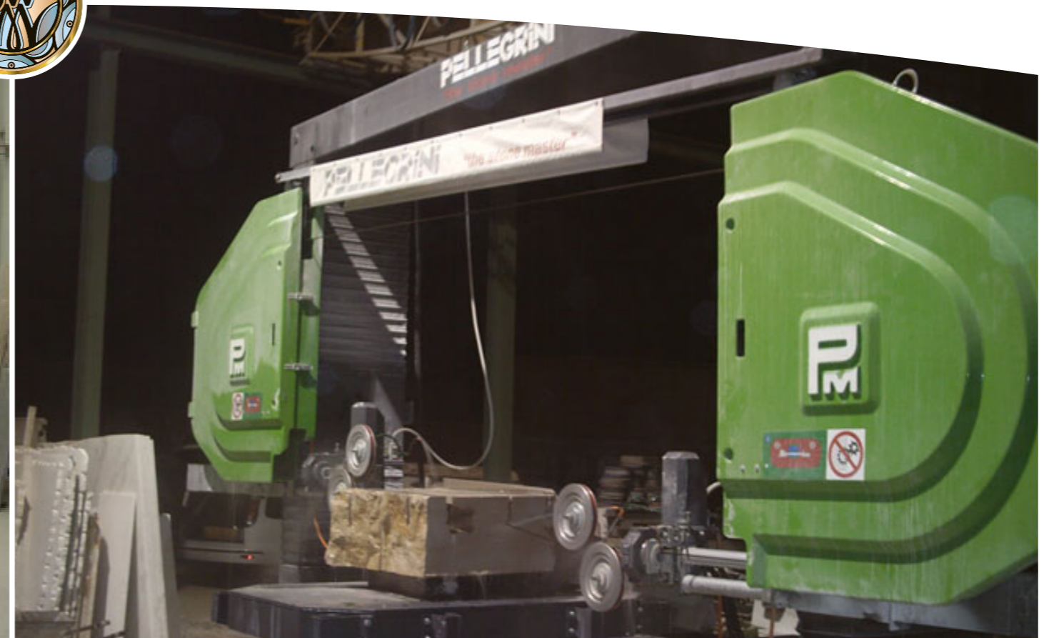
КАНАТНАЯ АЛМАЗНАЯ ПИЛА И 3D ПИЛА (PELEGRINI MECANICA SPA) ИСПОЛЬЗУЕТСЯ ГЛАВНЫМ ОБРАЗОМ ДЛЯ ПЕРЕВЯЗОЧНЫХ И КВАДРАТНЫХ БЛОКОВ И ДЛЯ РЕЗКИ ПЛИТ ЛЮБОЙ ТОЛЩИНЫ. СИСТЕМЫ ДЛЯ РЕЗКИ ДВУХ И ТРЕХМЕРНЫХ ПРОФИЛЕЙ С ИСПОЛЬЗОВАНИЕМ АЛМАЗНОЙ ПРОВОЛОКИ, ПОЛНОСТЬЮ С ЧПУ, УПРАВЛЯЕМЫЕ ПО ОСЯМ 2, 4 ИЛИ 6 DIAMOND ROPE SAW AND 3D SAW (PELEGRINI MECANICA SPA). USED MAINLY FOR DRESSING AND SQUARING BLOCKS AND FOR CUTTING SLABS OF ANY THICKNESS. SYSTEMS FOR CUTTING TWO AND THREE DIMENSIONAL PROFILES USING DIAMOND WIRE, ENTIRELY CNC CONTROLLED ON 2, 4 OR 6 AXES
